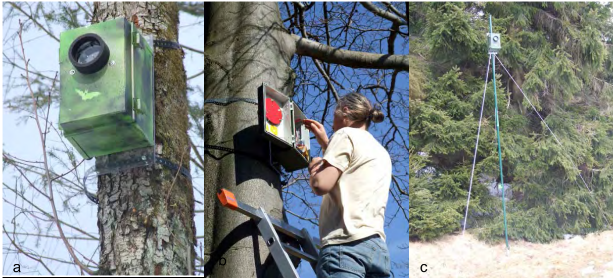
Abb. C-9: Erfassungstechnik: Waldbox (Fa. ecoObs Nürnberg). a: Waldbox in Tarnfarbe, b: Betreuung und Blick ins Innere: Batcorder, Mikrofon, Akku und GSM-Modul, c: auf 4 m Stange befestigtes Gerät im Gelände. Fotos: NACHTaktiv.
