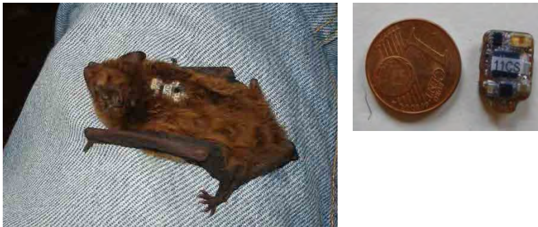
Abb. C-45: Geodatenlogger vom Typ GDL2-6 (2013). Logger für Kurzzeitdatenaufzeichnung ins Fell geklebt (hier N. leisleri ); Gewicht 0,6 g (beide Fotos: W. SCHORCHT).
