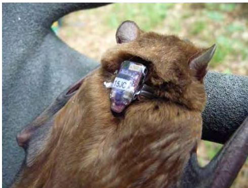
Abb. C-46: Geodatenlogger vom Typ GDL2-9 (2014). Logger an Halsband befestigt für Langzeitdatenaufzeichnung an N. noctula ; Gewicht ca. 0,6 g (Foto: F. LÖRCHER).
