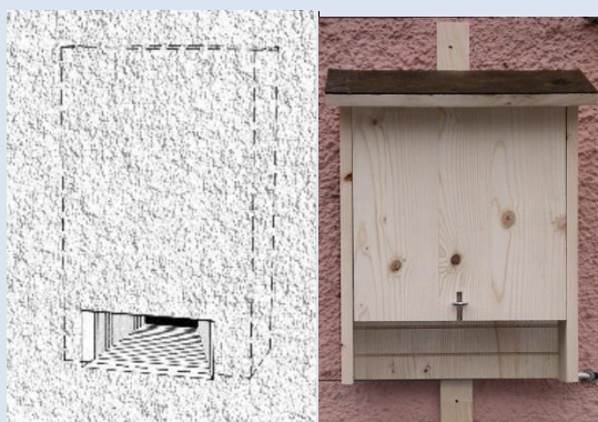
Fig. de gauche: modèle (Schwegler 1W1) prévu pour être directement intégré dans l'ouvrage
